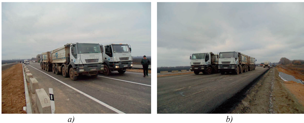
Рисунок 8 — Вигляд схем завантаження шляхопроводу із МГК із лівого проїзду (а) та правого проїзду (б) чотирма автосамоскидами IVECO
